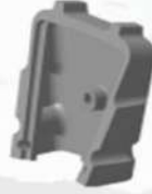
Kaldırıcı (Pulp lifter) Ağırlık: 660 kg, 20 adet
